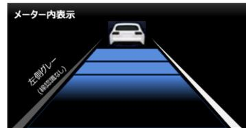
検証対象の道路を実走し、区画線の状態を撮影するとともに、LDA（Lane Departure Alert、区画線等を認識し車線逸脱の警告を発出する）のデータを収集した。LDA の認識率から区画線の劣化を推定することを目指し、実際の区画線の状態との比較検証を実施した。
