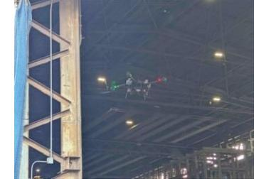
工場内での運搬スペースや飛行経路を確認し、水平・垂直方向の移動について検証した。様々な廃棄物の運搬方法を検討し、運搬可能な条件を明確化するとともに、コスト分析や技術課題の整理を行い、ドローン運搬の実現可能性を検証した。
