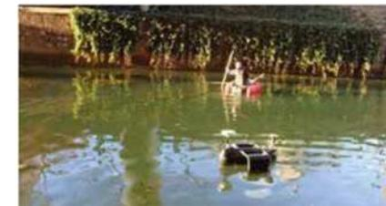
衛星通信環境のきびしい都心部における平面座標値の誤差、比較的水深が浅い運河での計測という課題の解決に向け、一級河川庄内川水系「堀川」において、25kHz 超音波センサーによるヘドロ計測、自律航行型無人ボートによる計測作業等の実証を行った。
