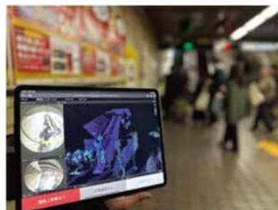
高精度のLiDARセンサーとAI技術を用いて、エスカレーターの利用状況をリアルタイムでモニタリングし、不適切な利用行動を検出・注意喚起するシステムを開発した。これを地下鉄伏見駅に設置し、エスカレーターの安全利用を促進できるかを検証した。
