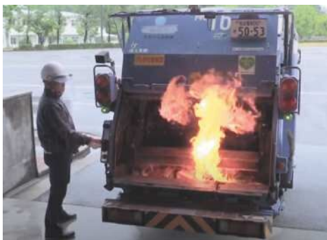
リチウムイオン電池による発火実験の様子 写真提供：独立行政法人 製品評価技術基盤機構（NITE）
