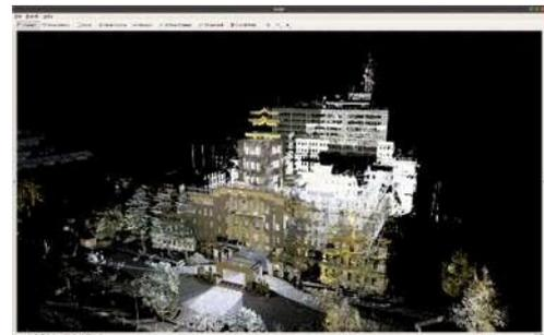
バックパック型の3次元データの測定器を活用した本庁舎の3次元地図データ化 (R2)
