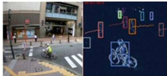
映像を AI で解析するプラットフォーム「Label Note」、「イベントセンサーカメラ」を活用した、自動車や歩行者の移動実態を調査できる仕組みの構築 (R3)
