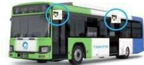
市バス車内の前後にある扉付近に AI カメラを設置し、個人情報保護に配慮しつつ、画像認識 AI を使ったバスの OD データを取得システムの構築 (R3)
