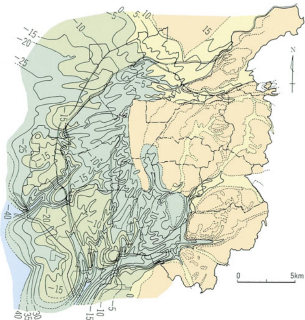
図2-23 沖積層の基底面等高線図(T.P.基準, m) (船戸・中島, 1986; 桑原ほか, 1986を修正・加筆) (土質工学会中部支部, 1988)
