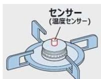
※ 安全装置(調理油過熱防止装置)には温度センサーが付いており、一定温度を超えないように自動的に火力の調整がされます。
