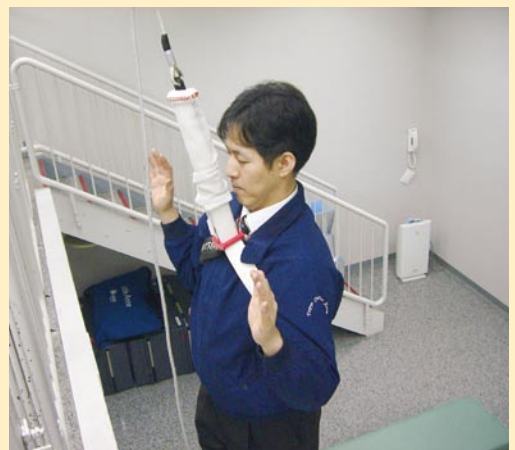
⑥ ロープ2本を握った状態で身体を建物の正面に向け、握ったロープを離し降下する
