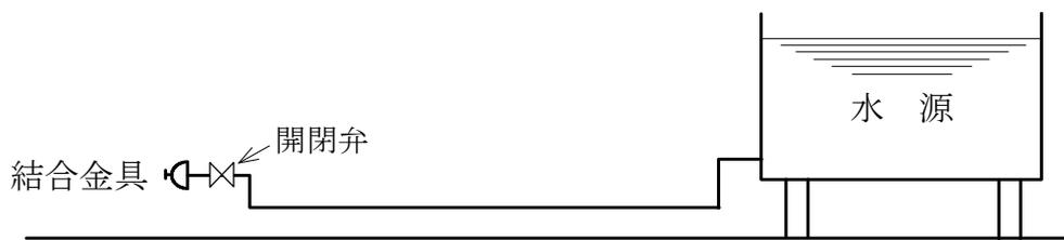
第17-1図 b 結合金具より下の水源地を有する消防用水
