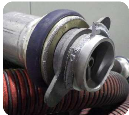
↑ 破損したホース
