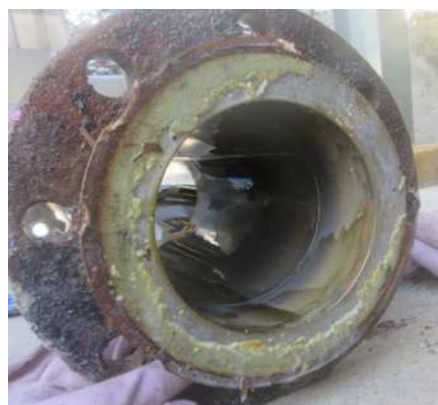
↑ ガスケット劣化、一部欠損
