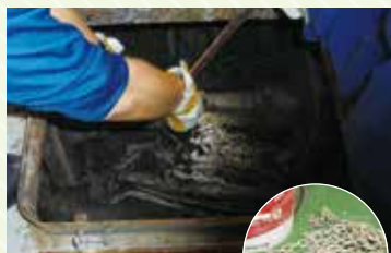
コンベヤに 噛み込んだ金属を 除去(富田工場)
