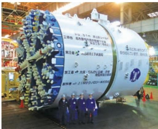
トンネル工事に使用するシールドマシン(直径約6m、長さ約8m、重さ約370トン)
