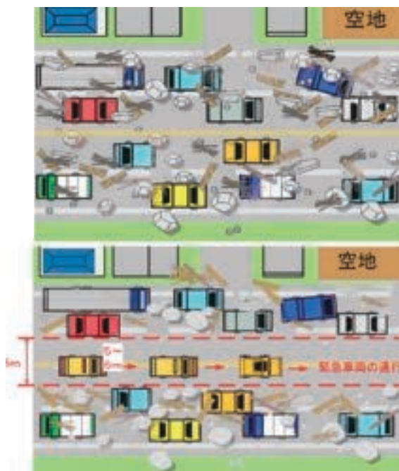
道路啓開作業のイメージ
