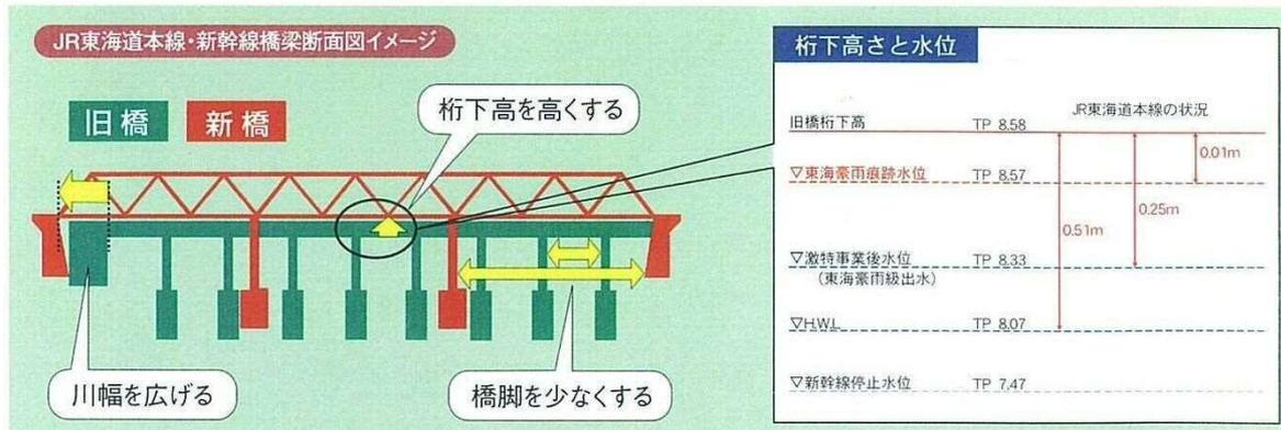
洪水の安全な流下を著しく阻害している枇杷島地区の橋梁改築（JR新幹線橋梁、JR東海道本線橋梁、県道枇杷島橋）を行うものであり、平成14年度に特定構造物改築事業が採択され事業着手された。
