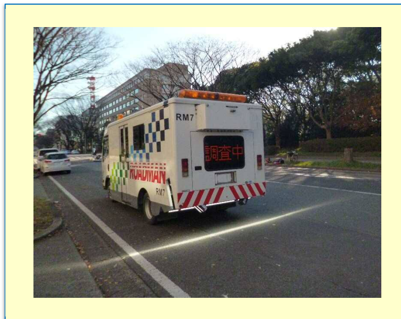
図-2.2 路面性状調査状況
