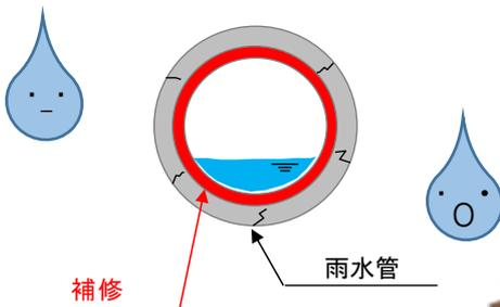
地中の傷んだ雨水管を道路を掘ることなく補修ができるため、作業日数や時間の短縮ができ、通行規制や騒音振動も少なくなります。
