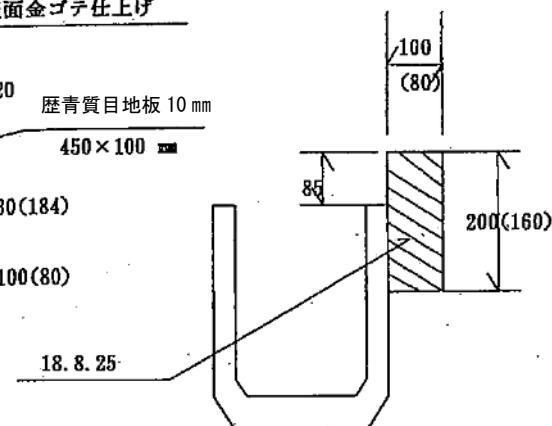
上図の街渠工Bの例では、設計延長 650mとした場合、図面の（ ）書以内の寸法であれば施工延長が 130mまで標準寸法で施工ができない場合でも標準単価を使用してもよい。
