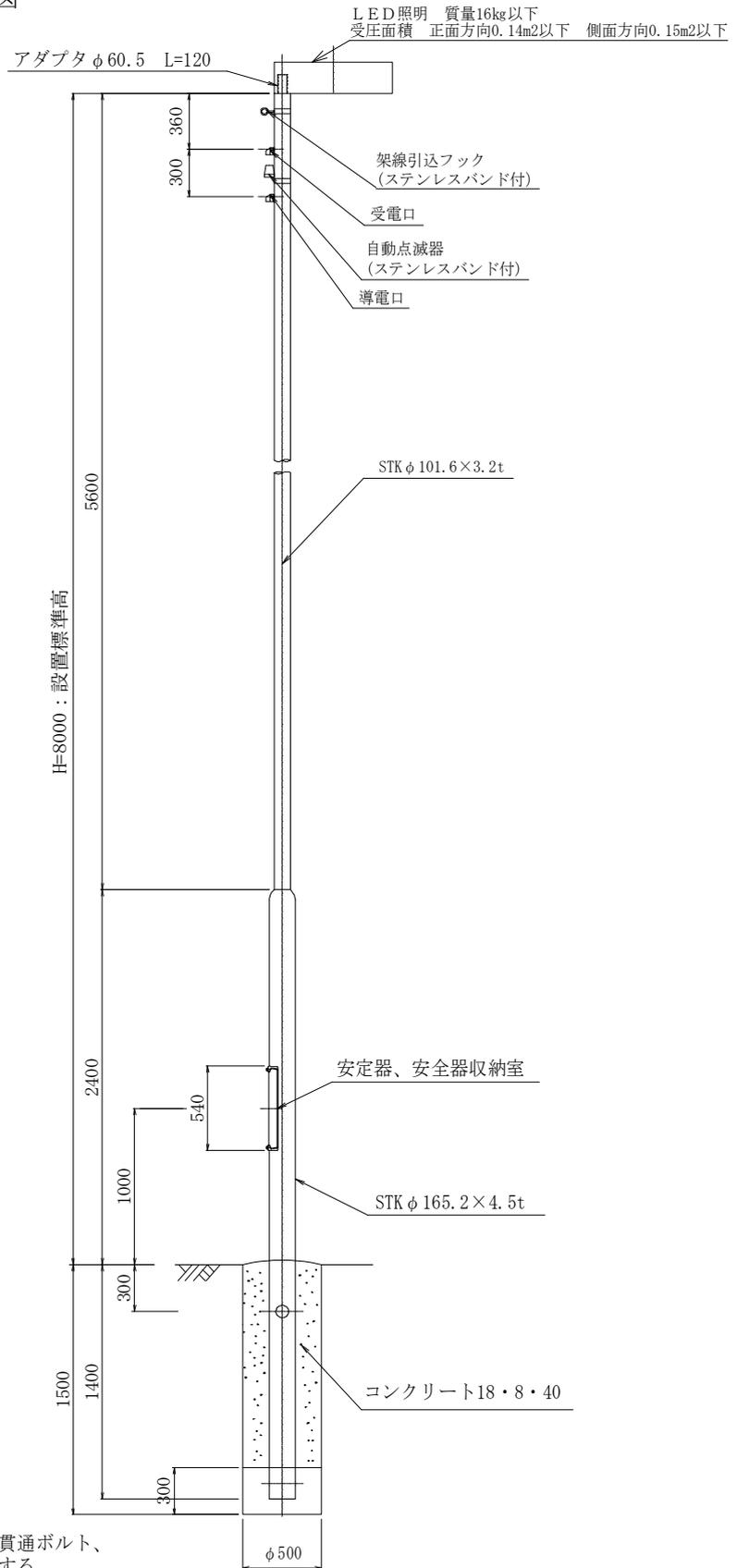
※灯具落下防止のため、灯具取付部にボール貫通ボルト、もしくは落下防止ワイヤを取付けるものとする。
