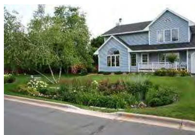
雨水貯留浸透施設（雨庭）
