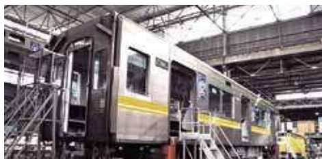
台車を外して点検・整備中の車体
