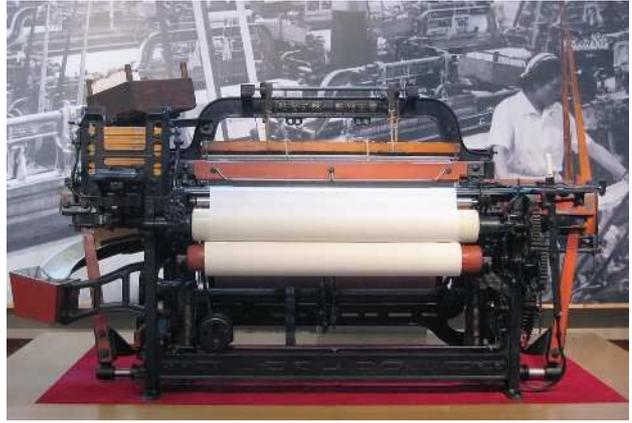
図 122 無停止杼換式豊田自動織機（G型）1号
