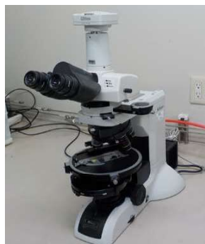
写真-1 偏光顕微鏡 (ECLIPSELV100ND（（株）ニコン社製））
