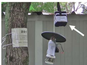
図 2. 蚊捕集用 CO<sub>2</sub>トラップ
