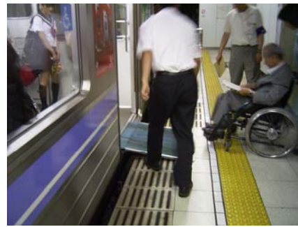
地下鉄車両への車いすによる乗降性を検証
