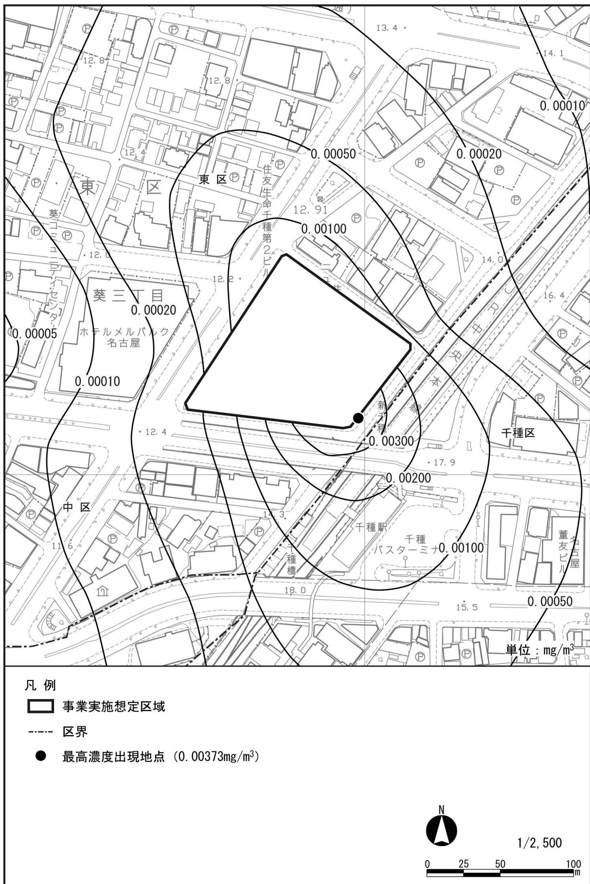
図 5-1-7(1) 建設機械の稼働による浮遊粒子状物質濃度の予測結果 (A 案)
