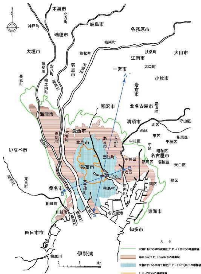
図 資-14 海拔ゼロメートル地帯 出典)令和5年における濃尾平野の地盤沈下の状況
