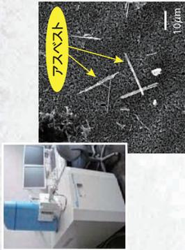
図3 電子顕微鏡による観察 (1000倍)
