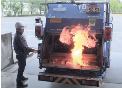
リチウムイオン電池による発火実験の様子
