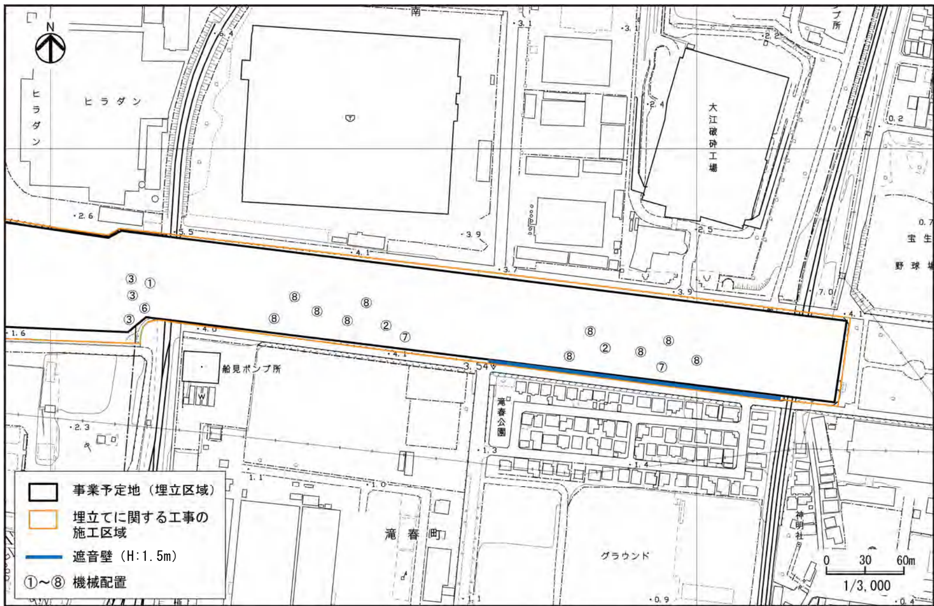
図 5-11-2(2) 建設機械の配置図 (上流側)
