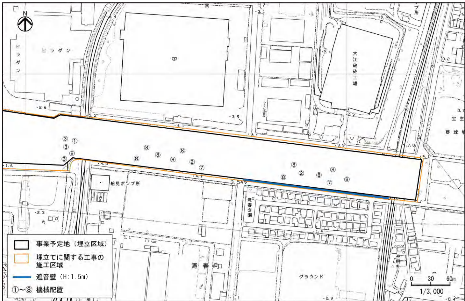
図 5-11-2(2) 建設機械の配置図 (上流側)
