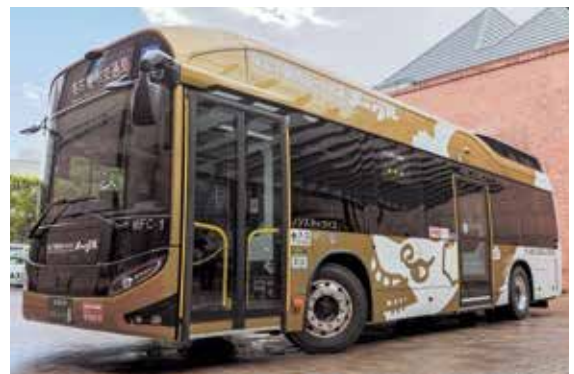
なごや観光ルートバス「メーグル」に導入した燃料電池バス
