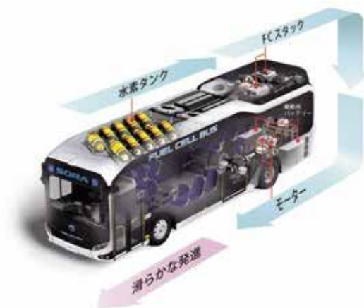
燃料電池バスが走る仕組み
