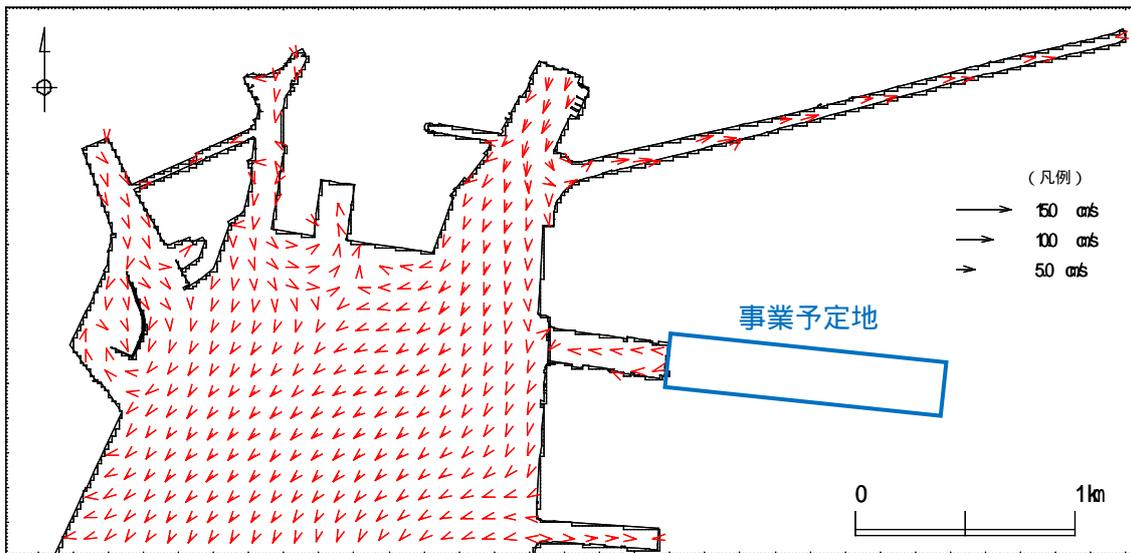
図 2-5-13(1) 防潮壁と埋立地両方の存在時の水象予測結果
