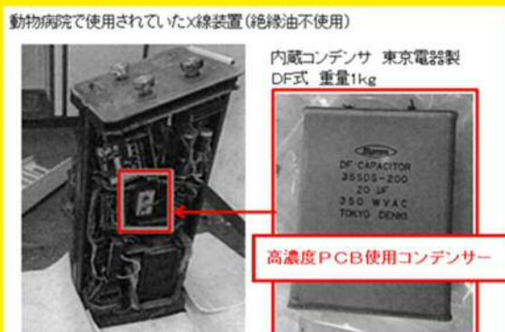
高圧発生器に、高濃度PCBを使用したコンデンサーが内蔵されていた場合
