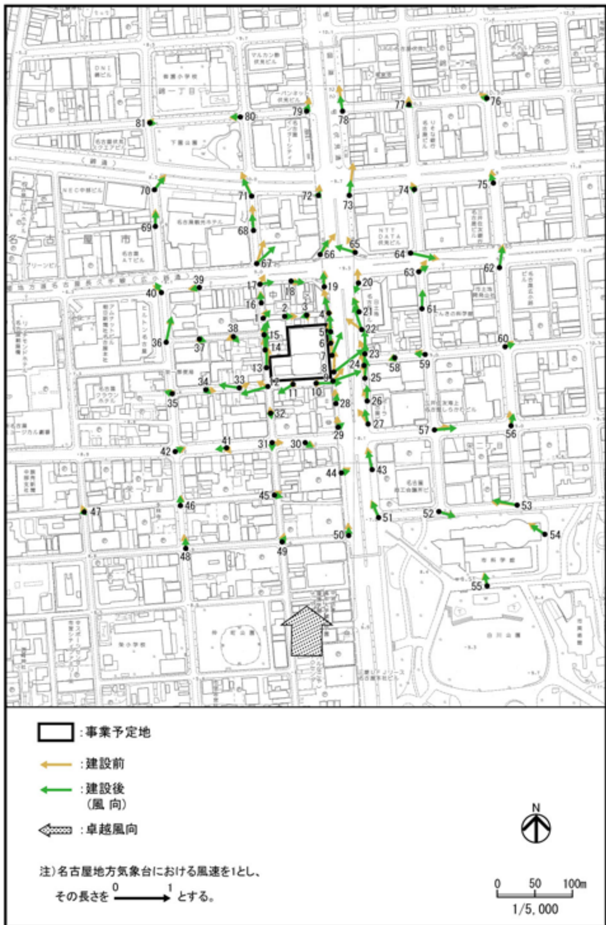
図 2-8-6(2) 風向及び風速の変化 (風向：S の場合)
