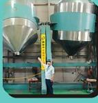
粉碎されたプラスチックを巨大なタンクに入れて回転させ、均等に混ざるようにします。
