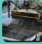
高熱でドロドロに溶かしたもの機械で細く押し出して、水で冷やして固めます。固まつものは、3mmぐらいの長さに切っていきます。これがプラスチック製品の材料になります！
