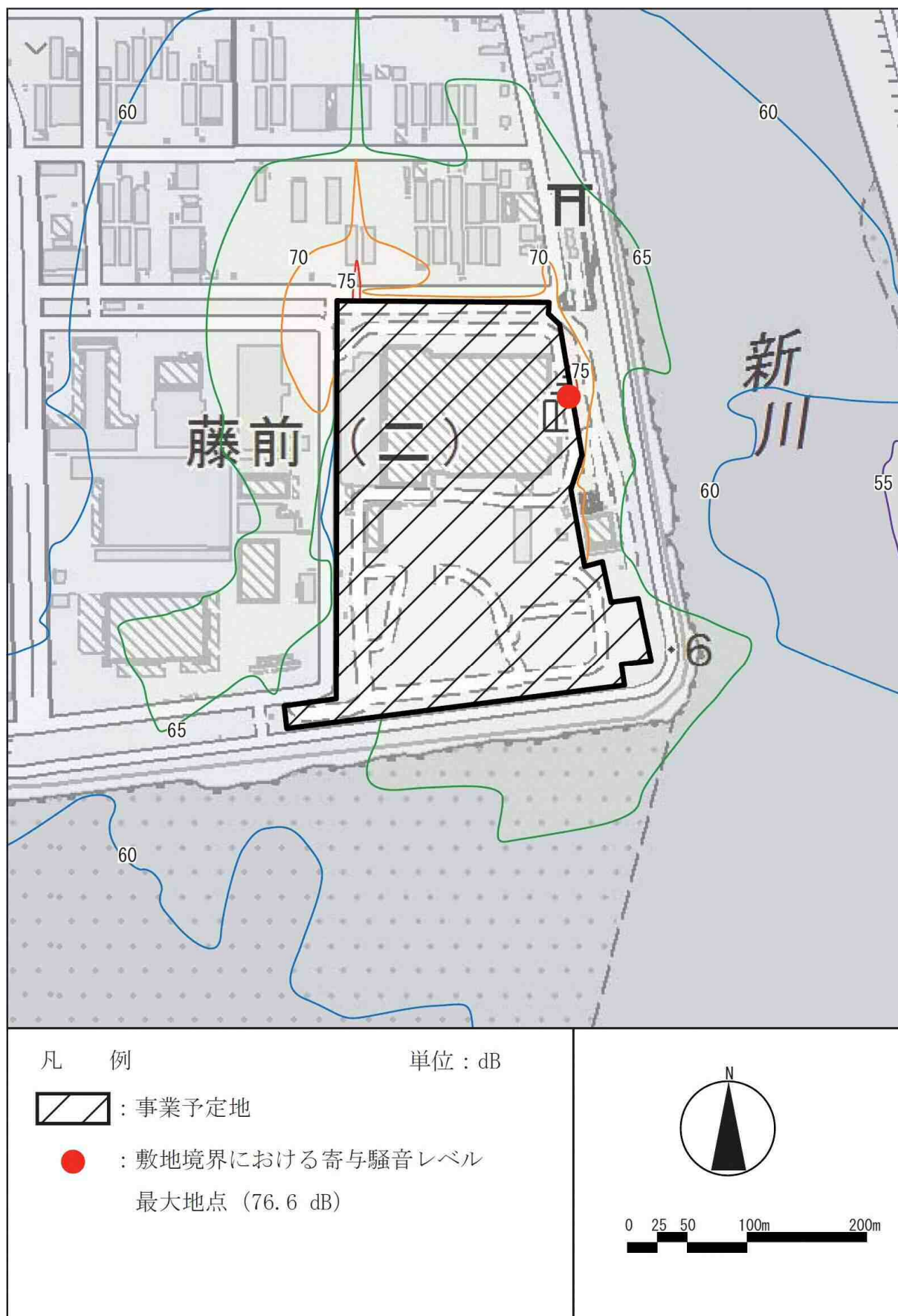
図 2-3-4 建設機械の稼働による寄与騒音の予測結果 (L A5 )
