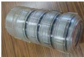
図1-2 フィルターバック法の捕集装置(写真) ろ紙の間に、それぞれろ紙(F0～F3)が セットされる
