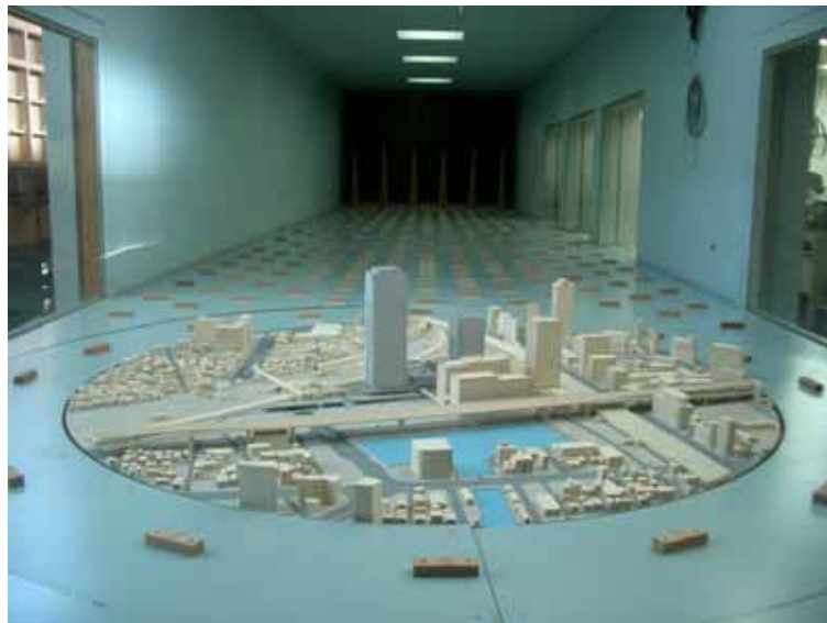
写真 2-9-1 模型の風洞内設置状況
