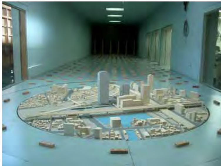
写真 2-9-1 模型の風洞内設置状況
