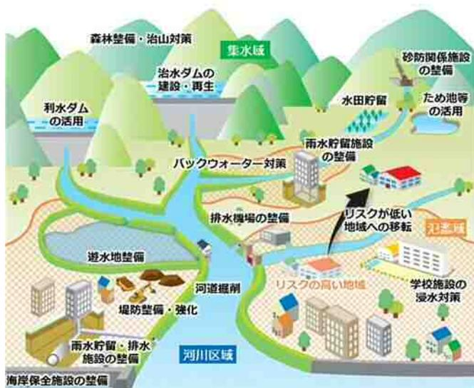
「流域治水」とは、堤防整備、ダム建設・再生などの対策をより一層加速させるとともに、さらに集水域（雨水が河川に流入するエリア）から氾濫域（河川等の氾濫により浸水が想定されるエリア）にわたる流域に関わる全員で水災害対策を行う考えです。
