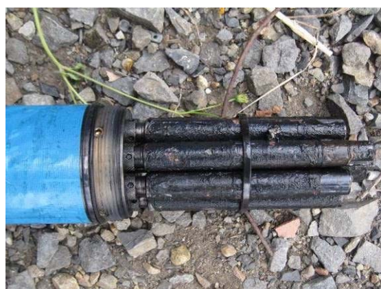
底層に設置したものは、還元状態のため硫化物イオンと銅が反応し、硫化銅となり真っ黒になった。
