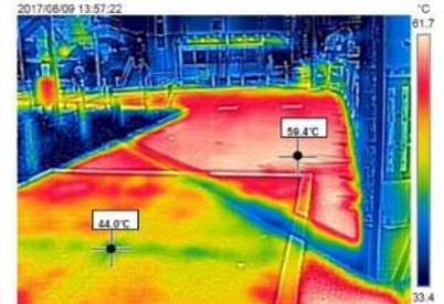
図 湧水（地下漏水）の活用事例（名古屋市昭和区川名駅）（2017～2020 年度、湧水を活用したヒートアイランド現象緩和の実証実験（名古屋市））
