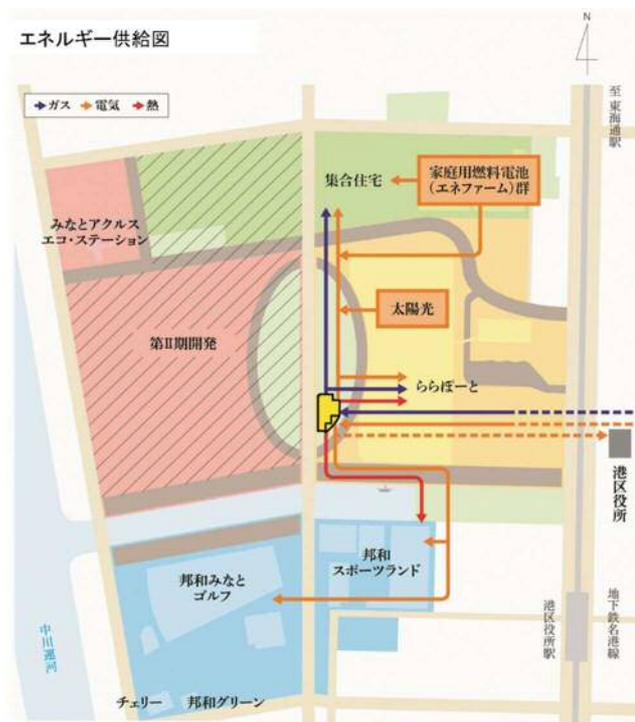
みなとアクルスは、旧東邦ガス(株)港明工場跡地で開発中のスマートタウン。電力需要の高い商業施設、熱需要の高いスポーツ施設などに中央に位置するエネルギーセンターから電気・熱・ガスを一括供給しており、まち全体で省エネルギー化・低炭素化を図っている。
