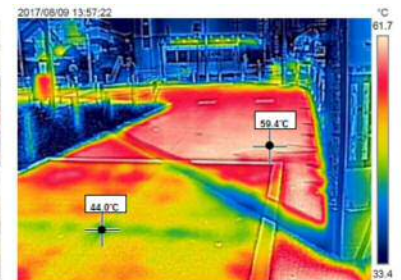
図 湧水（地下漏水）の活用事例（名古屋市昭和区川名駅）（2017～2020 年度、湧水を活用したヒートアイランド現象緩和の実証実験（名古屋市））
