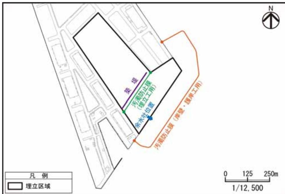
図 1-2-21 築堤、余水吐及び汚濁防止膜の位置
