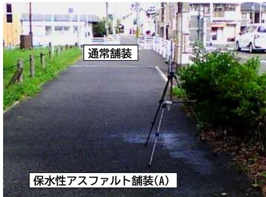
保水性アスファルト舗装 (A) の写真 (左) とサーモカメラ画像 (右) 撮影日：8月10日 (送水時間：54min/h)
