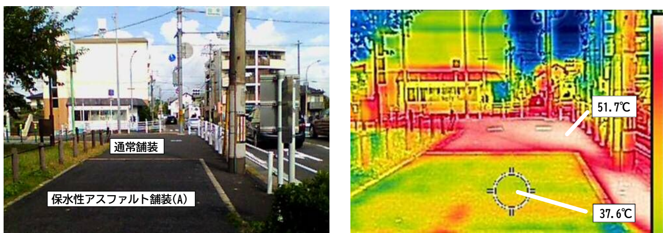
保水性アスファルト舗装 (A) の写真 (左) とサーモカメラ画像 (右) 撮影日：7月28日 (送水時間：54min/h)
