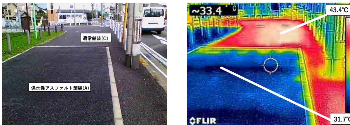
保水性アスファルト舗装 (A) の写真 (左) とサーモカメラ画像 (右) 撮影日：8月7日 (送水時間：54min/h)
