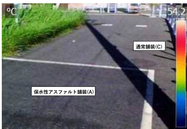
保水性アスファルト舗装 (A) の写真 (左) とサーモカメラ画像 (右) 撮影日：8月7日 (送水時間：54min/h)
