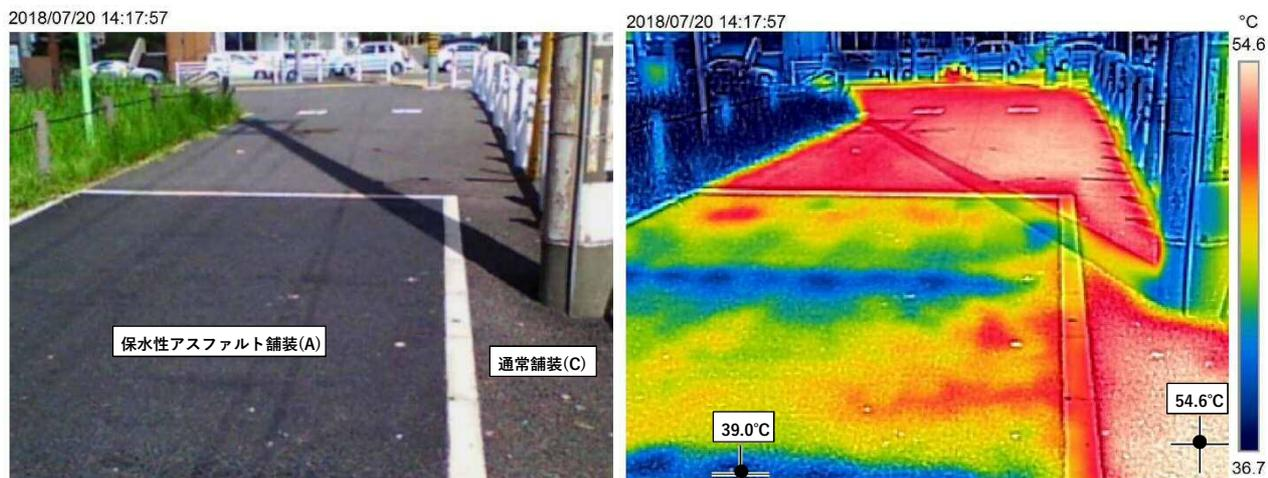
保水性アスファルト舗装 (A) の写真 (左) とサーモカメラ画像 (右) 撮影日：7月20日 (送水時間：40min/h)
