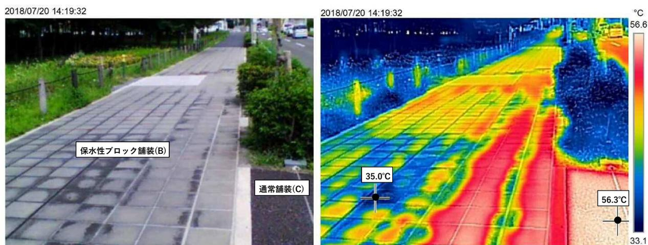
保水性ブロック舗装（B）の写真（左）とサーモカメラ画像（右） 撮影日：7月20日（送水時間：4min/h）
